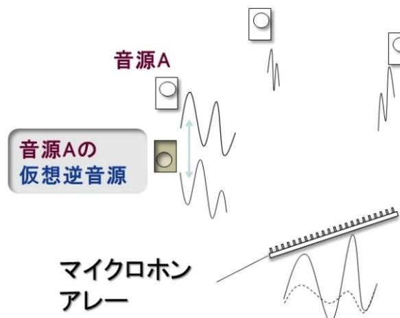
複数の音をマイクロホンアレーで受信し, 大きい音の信号を仮想的な逆音源で打ち消すことで小さい音の信号を抽出. スピーカーの音源で実証した. 筑波大の社会人学生としての博士論文. 内容の一部に入学前の職務成果を含むが, 入学後は休日夜間の自費での実験.
